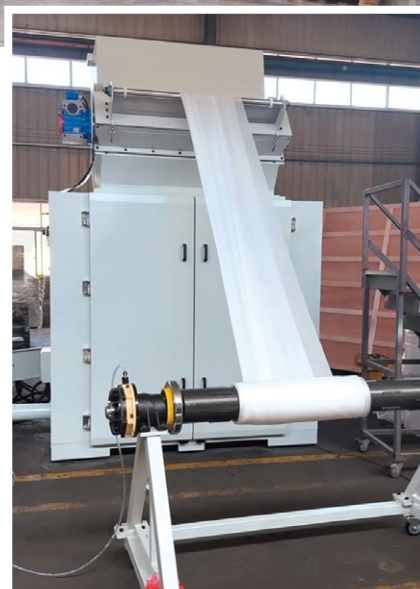
Дробильный комплекс ВМ56-130 для рулонов и пленки (реализованный проект «СОЛАН-Д»)
