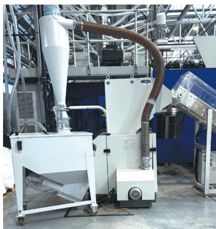
Дробилка для флаконов и канистр с циклонным фильтром (реализованный проект «СОЛАН-Д»)
